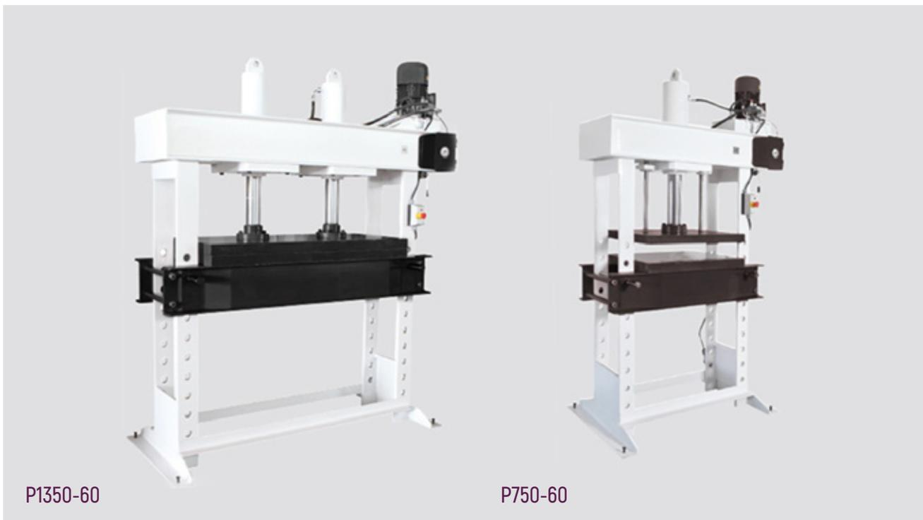
Prensa Hidráulica con sistema de cilindro monobloque en acero reforzado para prensar el Corian® y otros termoplásticos como el plexiglás o los PMMA y otros ABS.
